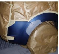
Als erstes beginnt man die Lackstelle zu bearbeiten, um sie dann zu grundieren. Diese wird nun getrocknet und mit feinem Nassschleifpapier geschliffen. Danach braucht man nur noch mit Wasserbasislack und Klarlack die vorbereitete Stelle zu lackieren.
